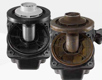
Магнетит и утайки се натрупват по помпата на отоплителния кръг.
