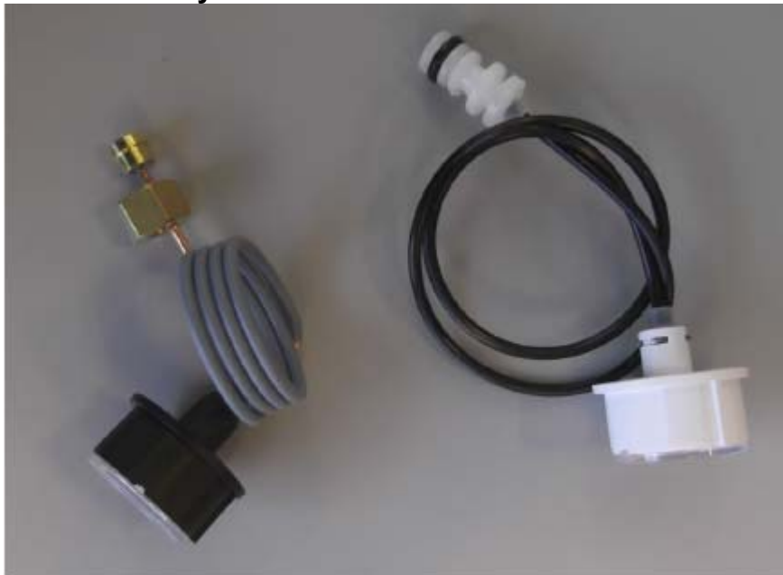
Obr. 1. Manometr trubice/kapilára stará/nová
