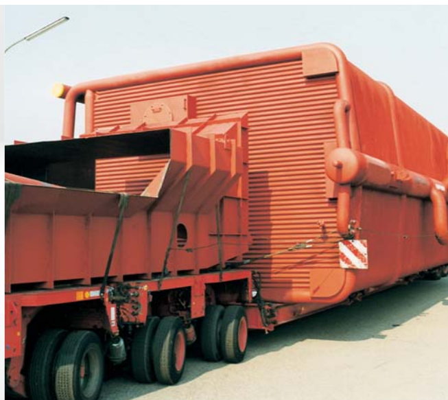
Obrázek 2: 100 MW horkovodní vodotrubný kotel při transportu
