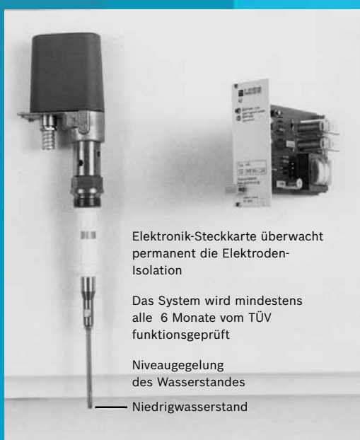
Bild 3: Zweikanalige Elektroden-Wasserstandseinrichtung – das System wird mindestens alle 6 Monate vom TÜV funktionsgeprüft
