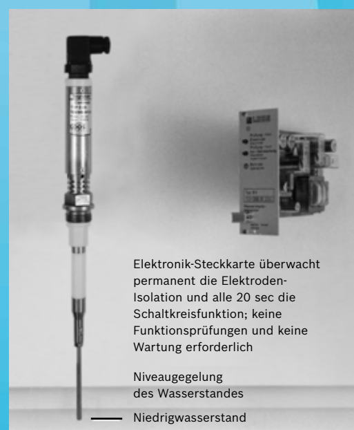
Bild 4: Selbstüberwachende Elektroden-Wasserstandseinrichtung – keine Wartung, keine Funktionsprüfung erforderlich
