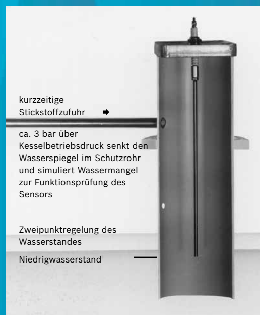
Bild 2: Einfache Elektrode – tägliche Zwangsprüfung durch Einblasen von Stickstoff
