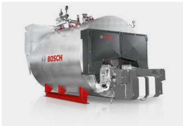
Abbildung 1: Versandfertiger Hochdruck-Großwasserraumkessel in Zweiflammrohrbauweise, 35 t/h, 16 bar
