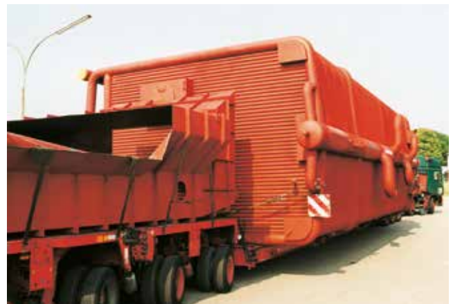
Abbildung 2: 100 MW Heißwasser-Wasserrohrkessel beim Transport
