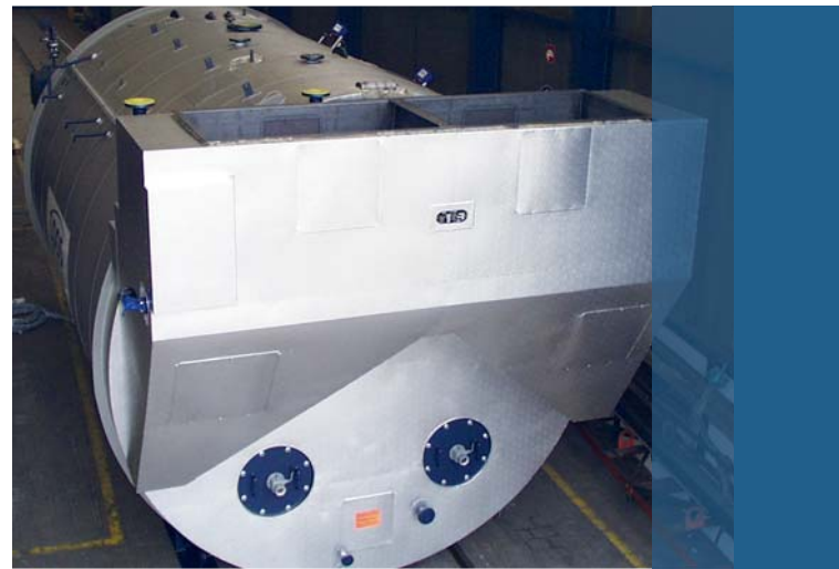
Economizador instalado para un funcionamiento individual no limitado de los quemadores
