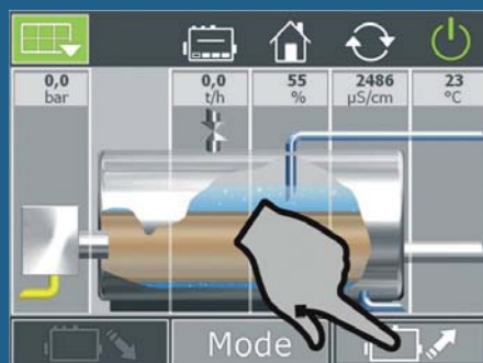
Imagen 3: Superficie de control del Boiler Control (BCO) – pulsando en el símbolo de la pantalla táctil „subir“ o mediante una señal externa se pone en marcha la caldera de forma totalmente automatizada.
