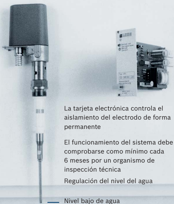
Ilustración 3: Dispositivo de control de nivel de agua de electrodos de dos canales: el funcionamiento del sistema debe comprobarse como mínimo cada 6 meses por un organismo de inspección técnica
