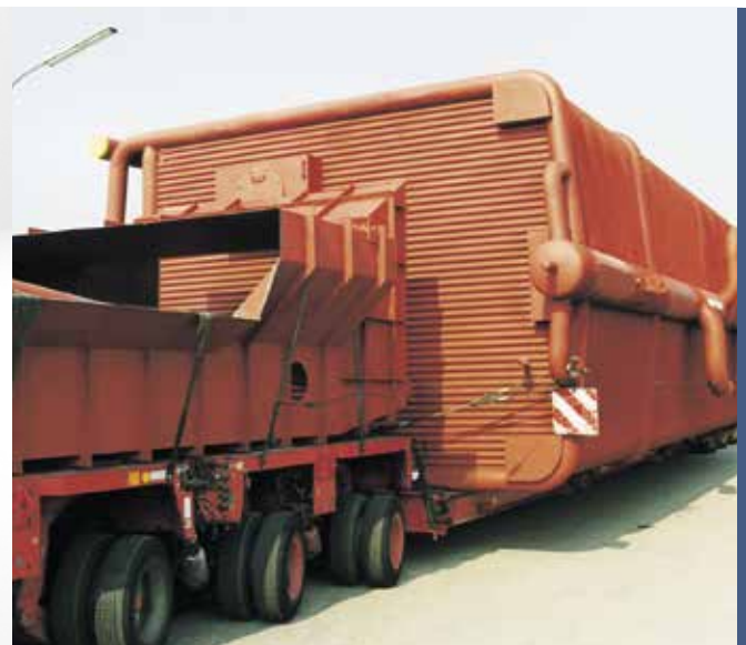
Imagen 2: Transporte de una caldera acuotubular de agua caliente 100 MW
