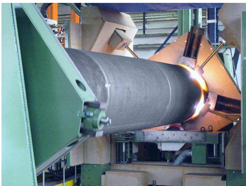
À gauche : machine à tube de flamme ondulée unique au monde - À droite : soudage Crédit photos : BOSCH THERMOTECNOLOGIE
