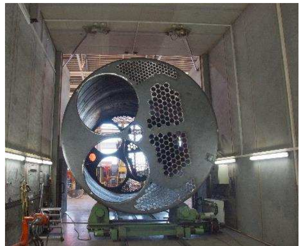
Contrôle qualité par rayons X - Crédit photo : BOSCH THERMOTECHNOLOGIE
