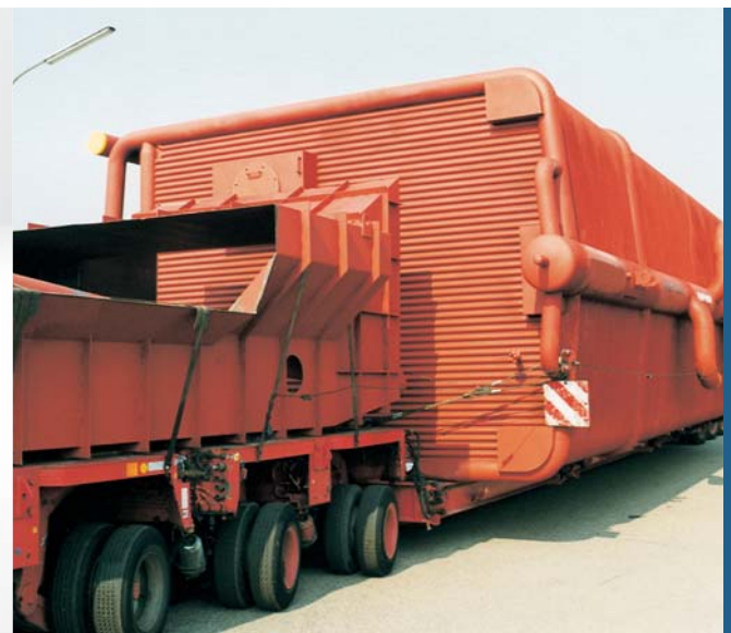
Figure 2 : Chaudière eau chaude 100 MW. Chaudière à tubes d'eau en cours de transport.
