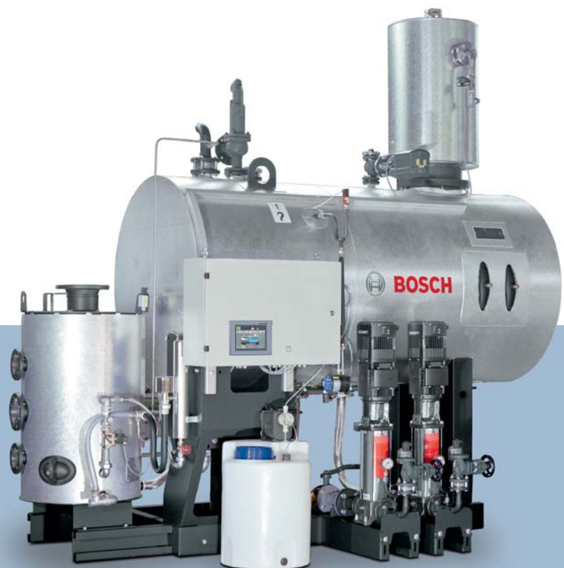
Figure 4 : Module de service pour l'eau WSM pour le dégazage, l'entreposage et le conditionnement chimique de l'eau d'alimentation des chaudières et pour la détente et le refroidissement des eaux de chaudière régulant la température.
