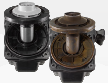
Vas- és iszaplerakódás egy szivattyún.
