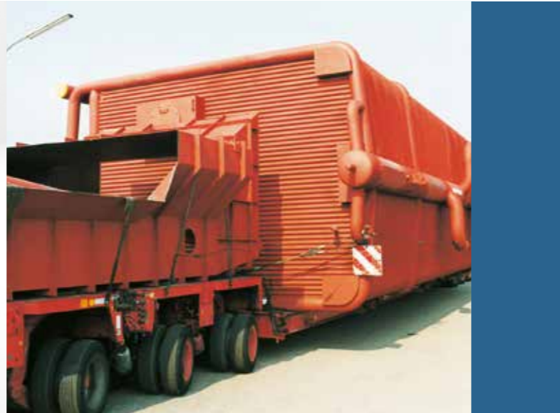
Şekil 2: 100 MW kızgın su - su borulu kazan nakledilirken
