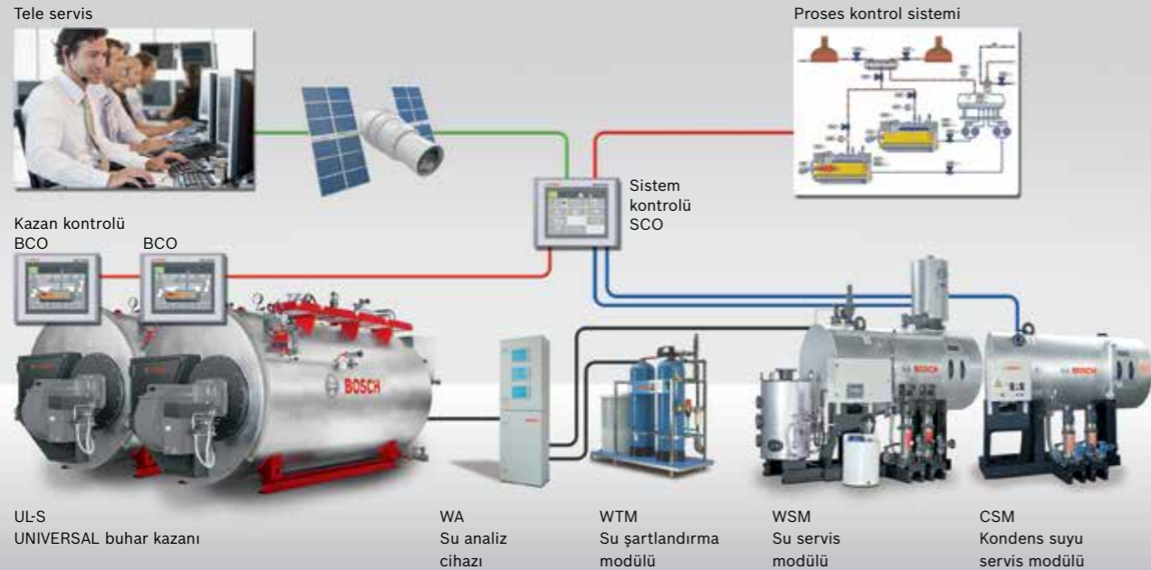
Şekil 9: Çoklu kazan sistemleri, su analizleri, su işleme, degazyon sistemleri, kondensat sistemleri, yakıt temini - SCO her şeyi kontrol altında tutar
